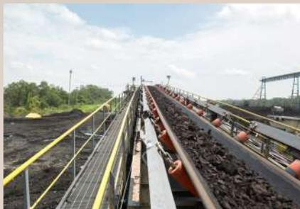
“Ada 3 fasilitas penanganan batu bara baru yang dibangun. Pertama yaitu dua *Train Loading Station* (TLS) dengan kapasitas masing-masing mencapai 3.000 ton per jam beserta rail loop. Kemudian dua *line Conveyor System* sepanjang 13 km dan 17 km, masing-masing berkapasitas 3.000 ton per jam. Selain itu, tiga Dump Hopper yang dapat digunakan dump truck kapasitas 60 ton dan 100 ton.
